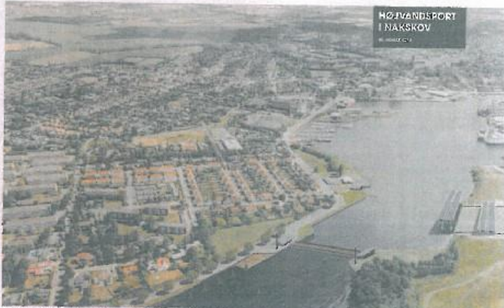
Når porten ikke er i brug, ligger den på bunden, så søljas foregår uhindret. Ved optryk til ekstrem højvande, rejser porten. På den fremmede illustration ses også, at Nakskov har fået byggeriet af de to nye støvsøsnæb. LUSTVAND. BY OG LANDSKAB
